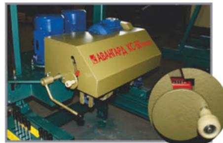
Кромкообрезное устройство может включаться в процессе пиления и отключаться за счет опускания-подъема пильного вала вертикальных дисковых пил посредством рычажного механизма.
