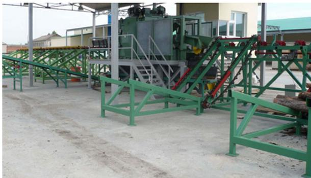
ООО «Авангард» разработан и запущен в серийное производство разобшитель бревен двух модификаций и линий их сортировки.
