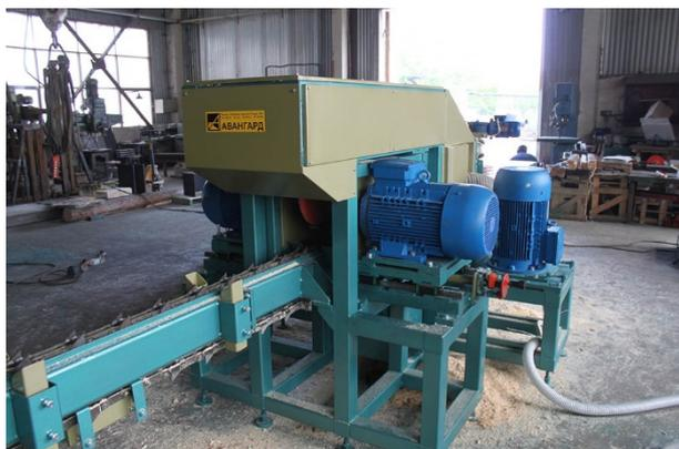
Фрезерно-брусующий станок «Авангард ФБМ-250» предназначен для переработки тонкомерной древесины в обрезную доску за один проход.
