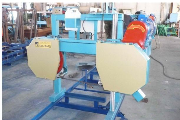
Ленточная пилорама «Авангард-ЛП-50» предназначена для распиловки брёвен диаметром до 500 мм из любых, в том числе твердолиственных, пород древесины на брус, доску обрезную, полуобрезную и необрезную, а также рейку при помощи ленточных пил.
