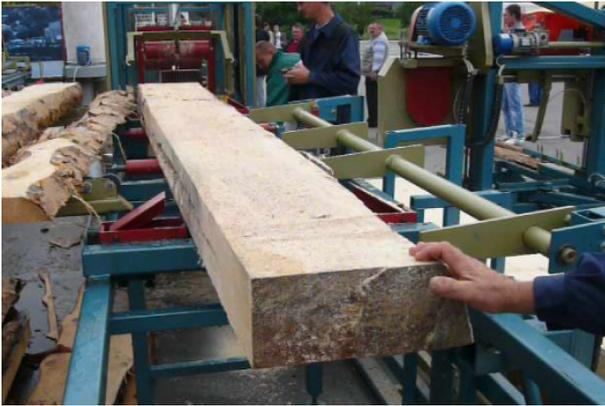
Центраторы лафетов модели «Авангард» являются дополнительным оборудованием к многопильным рамным станкам «Авангард-PM-50 М2-П», «Авангард-PM-50 М3» и дисковому многопильному станку «Авангард МД-16».
