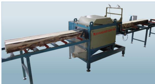
Дисковый многопильный станок «Авангард-МД-16» предназначен для распиловки двухкантного бруса шириной до 550 мм из любых, в том числе твёрдолиственных, пород древесины на доски при помощи дисковых пил, соответствующих различным породам древесины. При установке лазерных
