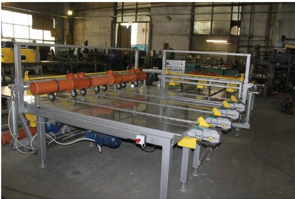
Станок предназначен для раскроя или обрезки по контуру плитных материалов с максимальными размерами разрезаемых плит – 2400×1200 мм.
