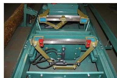
прижима распиливаемого сырья (в случае его деформации от снятия внутренних напряжений) к опорным поверхностям направляющих.
