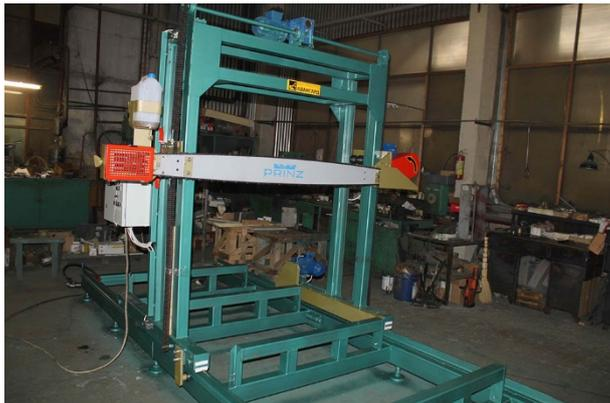
Станок предназначен для торцовки штабелей (пакетов) досок и резки их на определенный размер по длине. Также может быть использован для резки полиэтиленовых труб, бумаги, а также некоторых каменных материалов, например пенобетона, при установке специальных пильных цепей. Отрезка производится при вертикальном перемещении шины с пильной цепью. Двухопорная система
