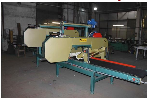
Ленточный делительный станок «Авангард-ЛП-80 S.E.N.-2Д-Ш» оснащен ленточным конвейером для подачи заготовки в зону резки. Распиловка производится ленточной пилой в горизонтальной плоскости при прохождении заготовки относительно неподвижно установленной ленточнопильной головки.
