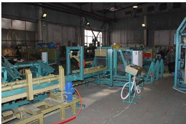
Линия предназначена для переработки древесины диаметром до 300 мм, длина исходного сырья – до 4,0 метров.
