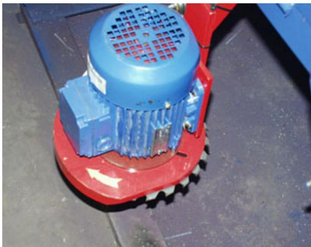
Окорочная фреза (дебаркер) предназначена для предварительной очистки коры бревен со стороны захода пильной ленты от песка, смолы, глины и других твердых включений. Очистка производится пропилом поверхности бревна дисковой фрезой с твердосплавными пластинами на регулируемую глубину. Фреза используется в составе ленточных пилорам «Авангард-ЛП-80». Применение окорочной фрезы позволяет значительно увеличить срок
