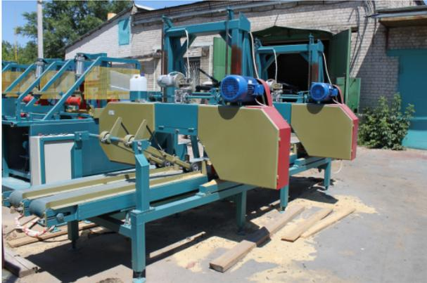
Ленточный делительный станок данной модели имеет две пильные головки, смонтированных на общем подрамнике с подающим ленточным конвейером, оснащенным пневмоприжимом. Данная модель имеет две пильные траверсы и один подающий конвейер. За один проход происходит отделение от каждого горбыля двух необрезных досок, поэтому станок целесообразно использовать в составе
