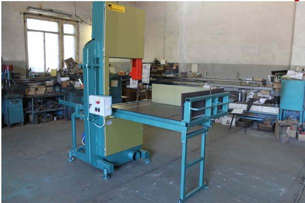
Станок предназначен для распиловки широкой гаммы материалов (в зависимости от установленного типа пильной ленты): различные пластики, резина, рулонные материалы, ячеистые бетоны, минеральная вата и другие материалы. Материал укладывается на подвижной стол, перемещением которого происходит распиловка материала.
