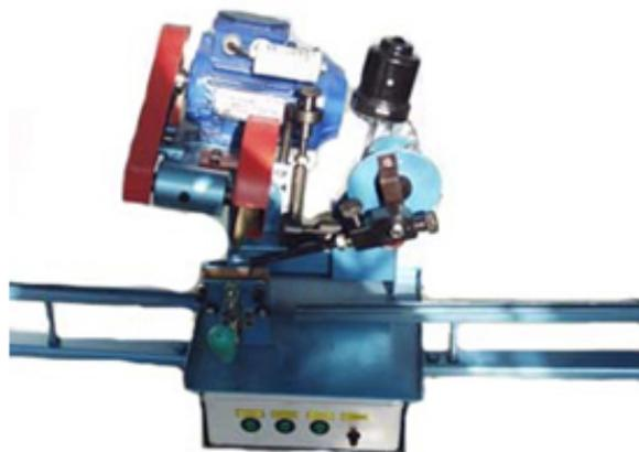
Автоматическое устройство для заточки зубьев рамных пил АЗУ-06 предназначено для автоматической заточки рамных пил обычным абразивным или алмазным кругом. В серийной поставке устройство настроено на заточку рамных пил производства «Авангард» длиной 608, 731 мм шириной 73 мм. По желанию заказчика устройство может поставляться с дополнительными кулачками для заточки пил других марок.
