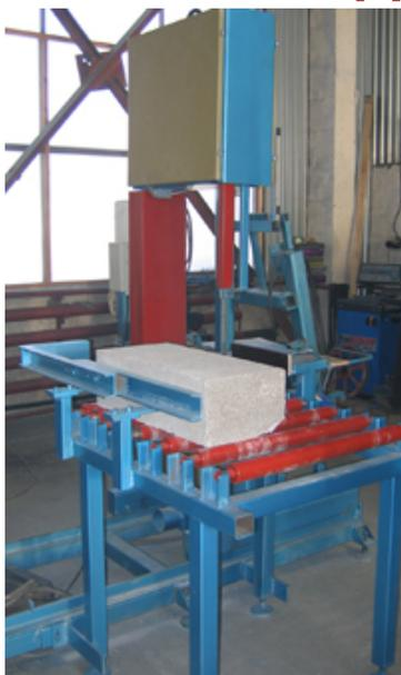
Станок предназначен для распиловки ячеистых бетонов. Станок оснащен роликовым столом на который укладывается распиливаемый материал. На столе установлен подвижный упор, который задает ширину отпиливаемой части. Перемещая пильную головку по рельсовым направляющим производится распил материала.
