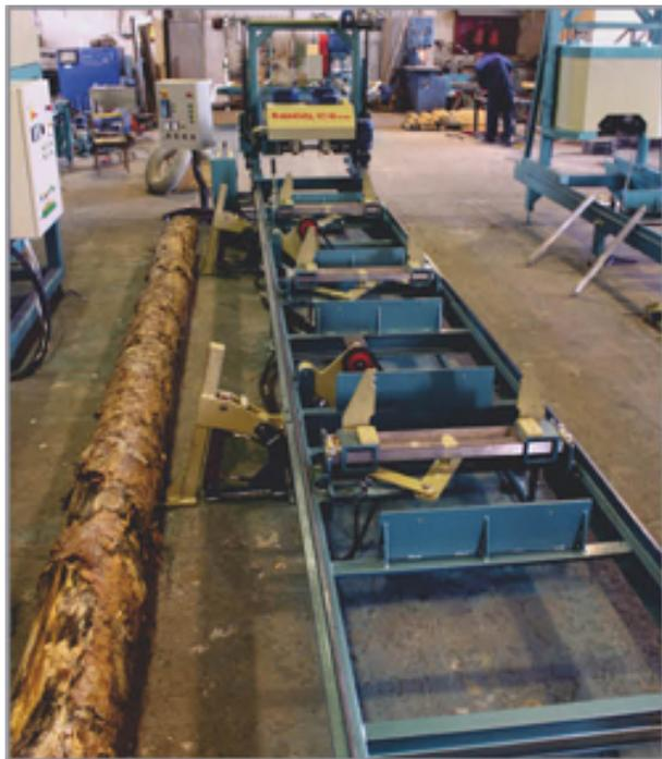
Дисковая пилорама «Авангард-КС-50-ПК» - это лесопильная установка, предназначенная для распиловки двумя дисковыми пилами круглого сырья диаметром до 500 мм и длиной до 6,2 м.
