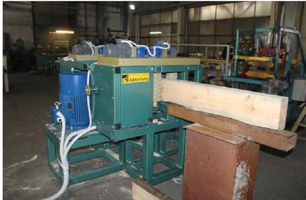
Дисковый многопильный станок «Авангард МДВ.2-16» предназначен для распиловки лафетов на обрезные доски и может агрегироваться с любым брусующим станком. Лафеты распиливаются в вертикальном положении, проходя через пильный узел с двумя вертикальными валами. Привод подачи – независимый от брусующего станка и состоит из 8-ми вертикально установленных приводных рябук.
