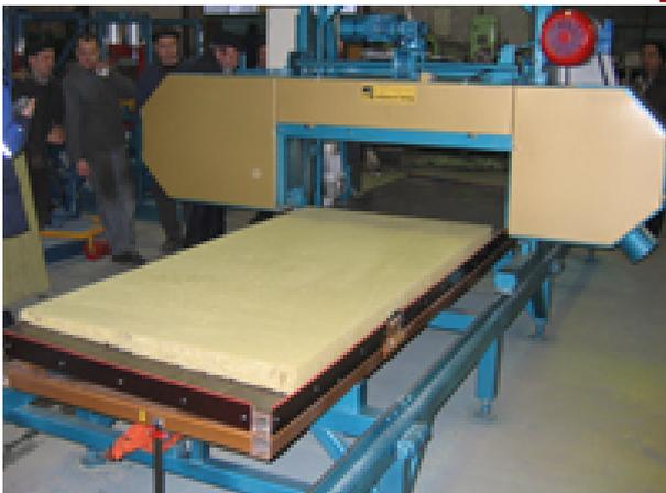
Установка для послойной резки минераловатных плит предназначена для распиловки минеральных плит по толщине от 12 до 300 мм с размерами 350x1000x3600 мм. Распиловка производится в горизонтальной плоскости перемещением ленточной пилы по направляющему пути при неподвижном положении плиты заготовки с возможным поворотом рабочего стола в 2-х плоскостях: от 0 до 5 градусов в продольном направлении и от 0 до 12
