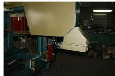
Управление гидравлическими механизмами направляющих пилорамы производится с второго пульта.
