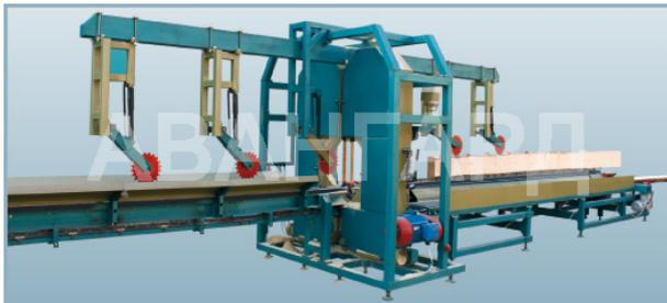
Вертикальные ленточнопильные брусующие станки серии "Авангард-ЛП-80-2Б" предназначены для распиловки брёвен диаметром до 450 мм из любых, в том числе твёрдолиственных, пород древесины на 2- и 4-кантный брус при помощи ленточных пил, соответствующих различным породам и
