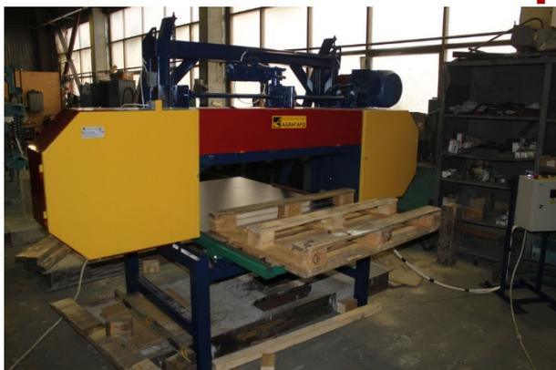
Станок предназначен для разборки деревянных поддонов с максимальными размерами 1200 × 1200 мм.
