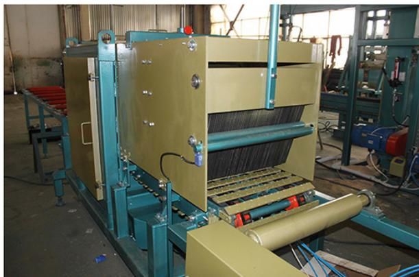
Многопильный станок предназначен для продольной распиловки круглыми пилами двух-трех-четырёхкантного бруса на доски и раскря досок на заготовки заданной толщины при механизированной подаче. Станок является аналогом многопильного станка модели WD-220KBA (WALTER).
