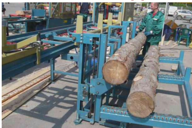
Подъемник модели "Авангард-Компакт" является вспомогательным оборудованием и предназначен для подъема пиломатериала в загрузочную зону многопильных станков "Авангард-PM-50" и модификаций. Подъемник не требует специального фундамента и, при наличии определенных навыков монтажа оборудования, устанавливается на жесткое ровное основание в течение 1...1,5 часов. Агрегируется с подающими рольгангами.
