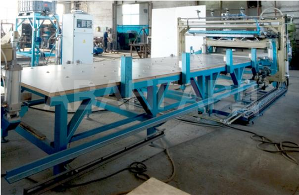
Линия по изготовлению структурных теплоизоляционных панелей (СИП – панелей) Авангард - ЛСП предназначена для изготовления сэндвич-панелей на основе OSB и пенополистирола. Сэндвич-панель СИП - это монолитная конструкция, полученная в результате склеивания под давлением двух плит OSB-3 и пенополистирола, используемого в качестве тепло-звукоизоляции. Линия
