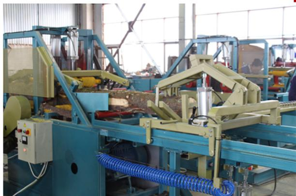
Для распиловки круглого лесоматериала большого диаметра, до 400 мм, создан рамный многопильный станок «Авангард-PM-50-M2-K2». В конструкции используются рамка, увеличенная по высоте, и гаттерные пилы, увеличенные по длине. В остальном конструкция аналогична модели «PM-50-M2-K».
