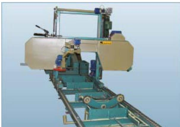
Горизонтальная ленточная пилорама «АВАНГАРД-ЛП-80 SEN» в полном оснащении относится к классу профессионального оборудования для распиловки круглого леса диаметром до 600 мм на необрезной и обрезной пиломатериал. Конструкции подвижной пильной каретки и направляющих для ее перемещения собраны из толстостенных профильных труб, что обеспечивает их жесткость и отсутствие вибрации.
