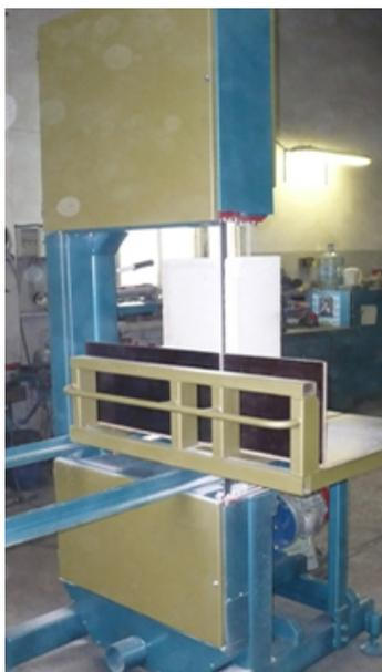
Станок предназначен для распиловки широкой гаммы материалов (в зависимости от установленного типа пильной ленты): различные пластики, резина, рулонные материалы, ячеистые бетоны, минеральная вата и другие материалы. Материал укладывается на подвижной стол, перемещением которого происходит распиловка материала.
