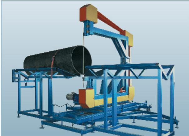
Ленточнопильный станок «Авангард-ЛС-50-1200» предназначен для распиловки пластиковых труб и оболочек диаметром до 1200 мм под углами от 0 до 45 градусов к торцу трубы.
