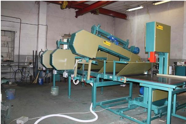
Для выполнения функции продольной резки заготовок минераловатных плит станок ЛП-80-3Д-1200 может быть дооснащен вертикальным ленточнопильным узлом на базе станка ЛС-50-600, который устанавливается перед ленточным конвейером станка ЛП-80-3Д-1200 на калиброванных рельсовых направляющих.
