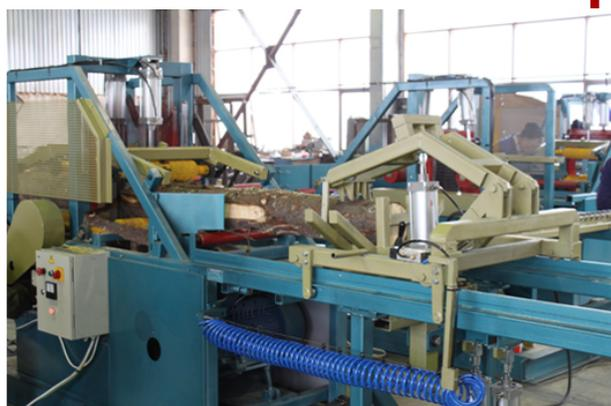
Многопильный станок «Авангард-РМ-50-М2-К» совмещает в себе общую для всех многопильных станков функцию распиловки лафетов на обрезные доски и **дополнительную возможность распиловки круглых лесоматериалов диаметром до 300 мм.** Для этих целей подающий и приемный рольганги удлинены и оснащены тележками, обеспечивающими зажим сырья в процессе пиления для
