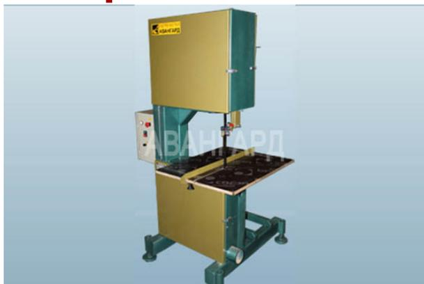
Универсальные вертикальные ленточнопильные станки серии “АВАНГАРД LC-50” предназначены для прямолинейной и фигурной распиловки древесных материалов в столярном производстве, а также, при соответствующем подборе ленточной пилы, на этих станках можно распиливать широкую гамму материалов: различные пластики, резину, рулонные материалы, ячеистые бетоны и другие материалы, включая цветные
