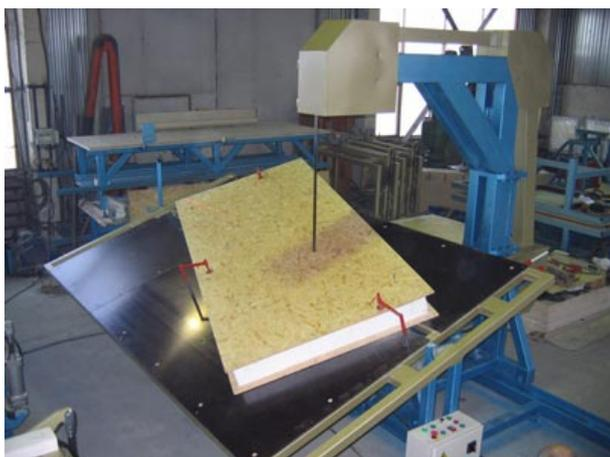
Возможен раскрой от 1 до 5 шт. панелей одновременно в продольном и поперечном направлении как под прямым углом, так и под любым углом, устанавливаемом по лазерному указателю.
