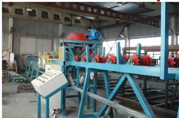
ООО «Авангард» разработаны и запущены в серийное производство две модификации разобшителей бревен и линий их сортировки.
