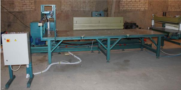
Линия по изготовлению структурных теплоизоляционных панелей (СИП – панелей) Авангард ЛСП-1 предназначена для изготовления сэндвич-панелей на основе OSB и пенополистирола. Сэндвич-панель СИП - это монолитная конструкция, полученная в результате склеивания под давлением двух плит OSB-3 и пенополистирола, используемого в качестве теплозвукоизоляции.
