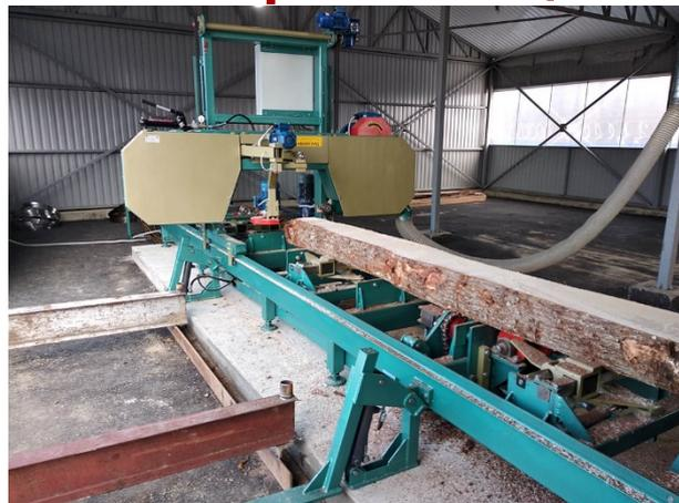
Направляющие оснащены механизмами загрузки бревна, его кантовки, продольного перемещения и фиксации. Все эти механизмы имеют гидравлический привод и управляются оператором с единого пульта управления.
