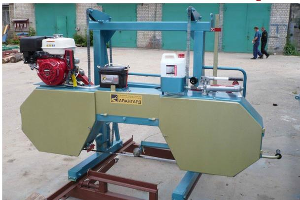
Ленточная пилорама «Авангард-ЛП-60-А» предназначена для распиловки брёвен диаметром до 650 мм из любых, в том числе твердолиственных, пород древесины на брус, доску обрезную, полуобрезную и необрезную, а также рейку при помощи ленточных пил, соответствующих различным породам и диаметрам древесины. Технические данные пилорам позволяют производить
