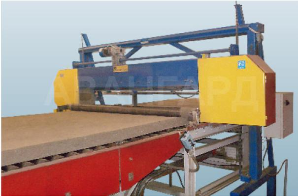
Станки ленточнопильные модели Авангард-ЛП-80-ТП предназначены для распиловки ковра минваты по толщине от 20 до 250 мм.
