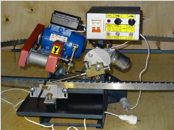
Автоматическое устройство для заточки зубьев ленточных пил АЗУ-05 предназначено для автоматической заточки ленточных пил обычным абразивным или алмазным кругом с использованием СОЖ.
