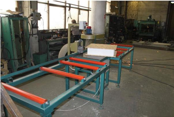
Станок предназначен для выборки пазов в пенопласте СИП-панелей при их раскрое. Станок не требует специального фундамента и устанавливается на твердое ровное основание в течение 1 часа.
