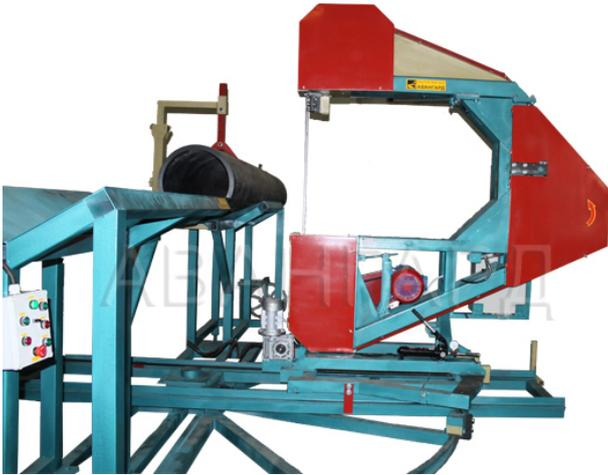
Ленточнопильный станок Авангард-ЛС-50-850 предназначен для распиловки пластиковых труб и оболочек диаметром до 850 мм под углами от 0 до 67,5 градусов к торцу трубы.
