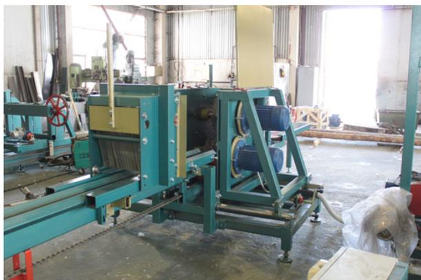
Дисковый брусующий станок предназначен для продольной распиловки круглого леса с целью получения на выходе двухкантного бруса.
