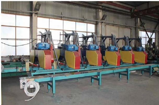
Станок предназначен для деления по толщине горбыля, трехкантных и четырехкантных брусьев. Станок включает в себя от 3 до 6 горизонтальных ленточнопильных узлов, смонтированных на общем подрамнике с подающим ленточным конвейером, оснащенный пневмоприжимами.
