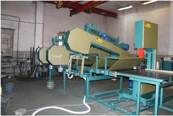
Станок предназначен для деления по толщине различных материалов, в том числе минераловатных плит. Станок включает в себя 3 горизонтальных ленточнопильных узла, смонтированных на общем подрамнике с подающим ленточным конвейером, оснащенным прижимами.
