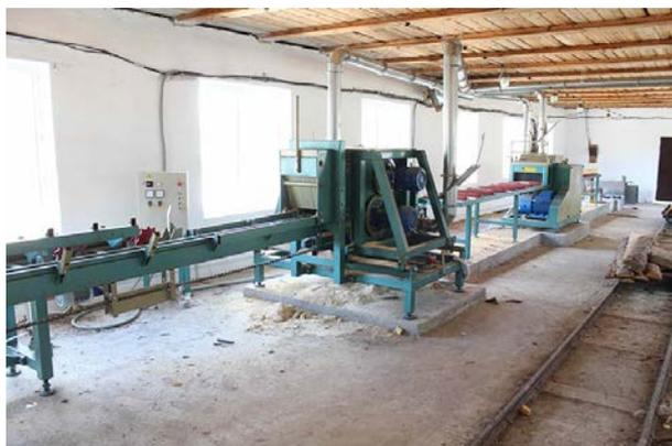
Линия предназначена для переработки древесины диаметром до 300 мм, длина исходного сырья – до 6,0 метров.
