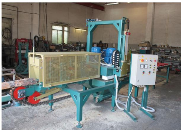
Станок реброво-горбыльный КС-50РГ является модификацией станков серии КС-50 и предназначен для распиловки горбыля на обрезную доску за один проход. Станок также может выполнять функции делительного и кромкообрезного станков.
