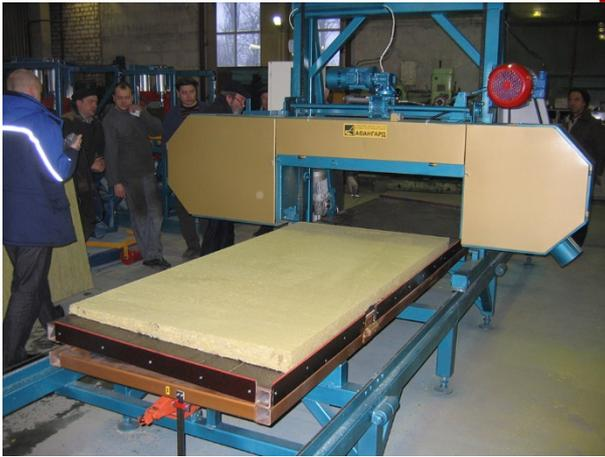
Станок ленточнопильный модели Авангард-ЛП-80-ТП-2 предназначен для распиловки минераловатных плит по толщине от 10 до 250 мм.
