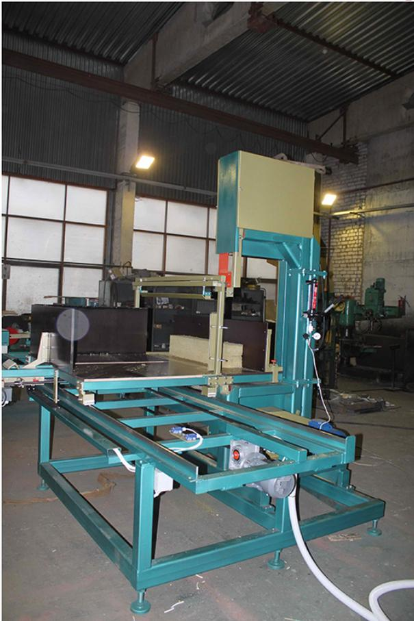
Станок предназначен для распиловки пакета минерало-ватных плит на ламели.
