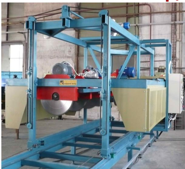
Конструкция линии включает в себя стол длиной 20 м с рельсовыми направляющими, на котором одновременно выставляется 14 моноблоков. На рельсовых направляющих стола размещаются два пильных блока для продольной и поперечной распиловки моноблока. Приводы перемещения пильных блоков порельсовым направляющим независимы.
