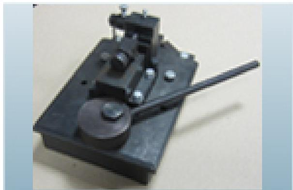
Предназначено для разводки зубьев ленточных пил шириной 32-51 мм.
