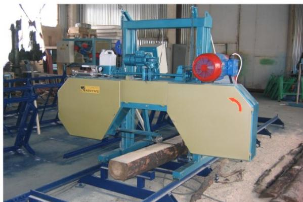
Пилорама «Авангард-ЛП-80» оснащена увеличенными пильными шкивами диаметром 660 мм и электромеханическим приводом пильной каретки и предназначена для распиловки брёвен диаметром до 800 мм из любых, в том числе твердолиственных, пород древесины на брус, доску обрезную, полуобрезную и необрезную, а также рейку при помощи ленточных пил,
