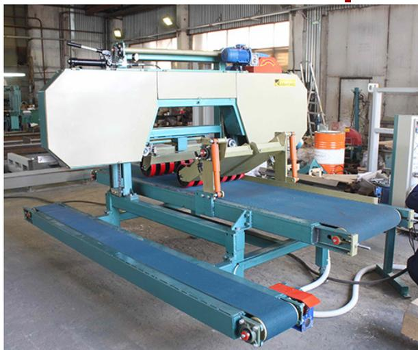
Ленточный делительный станок предназначен для послойной распиловки (деления по толщине) широкоформатных материалов (мебельных щитов и пр.).
