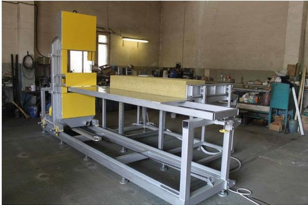
Станок предназначен для распиловки пакета минерало-ватных плит на ламели. Принцип работы: Пакет минерало-ватных плит укладывается на автоматизированный подающий стол. Подача пакета плит в зону резки осуществляется программируемым толкателем. Распиловка производится перемещением вертикального ленточнопильного узла по калиброванным направляющим. Отделенные от пакета ламели остаются на неподвижном столе станка, откуда обратным ходом пильного узла удаляются из зоны резки.
