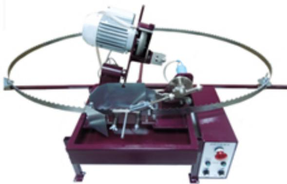
ПЗСЛ 30/60 ОПТИМА — боразоновый станок для автоматической заточки ленточных пил профильными эльборовыми (боразоновыми) кругами.
