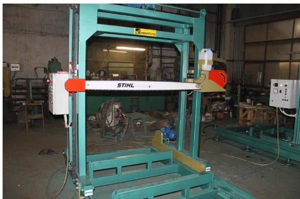
Станок предназначен для торцовки штабелей (пакетов) досок и резки их на определенный размер по длине. Также может быть использован для резки полиэтиленовых труб, бумаги, а также некоторых каменных материалов, например пенобетона, при установке специальных пильных цепей. Отрезка производится при вертикальном перемещении шины с пильной цепью. Двухопорная система крепления шины
